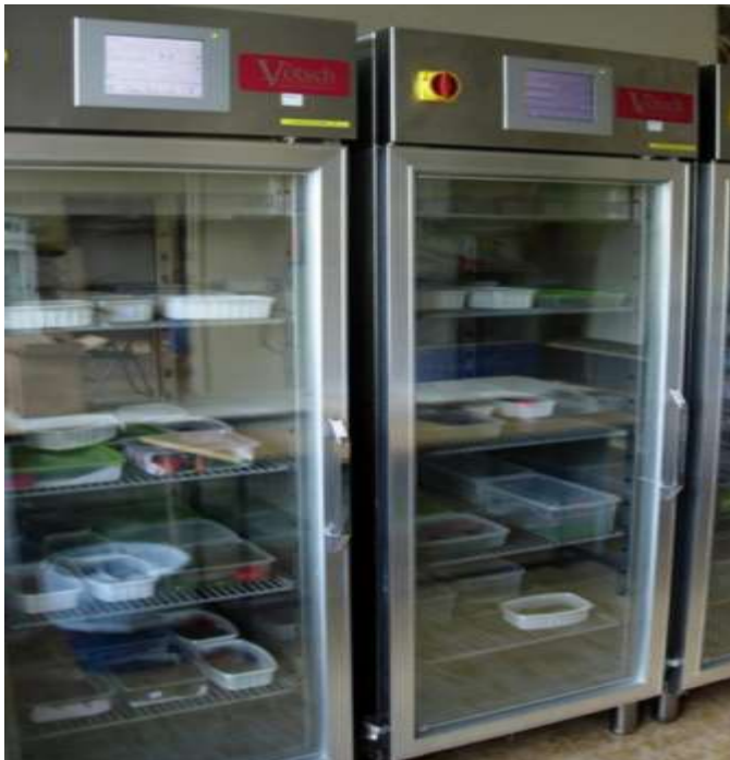
Fig. 271. Enceintes climatiques du CEBC-CNRS permettant le contrôle des conditions hydriques et thermiques journalières. Cet équipement offre une opportunité pour examiner les conséquences des contraintes thermiques et hydriques chez les ectothermes.
