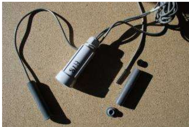
Fig. 24. Illustration d'un modèle biomimétique de lézard fait d'une sonde enregistreuse HOB0 Onset de type U23-003 Ext T / Ext T et de ses deux capteurs insérés dans les tubes en PVC qui imiteront sur le terrain les lézards en situation d'insolation et en situation de retraite au gîte (© F. D'Amico).
