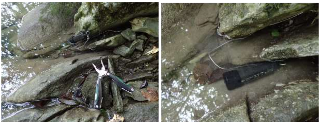
Fig. 18. Installation sur le terrain d'une sonde Onset HOBO Water Temp Pro v2 étanche (modèle U22-001).
