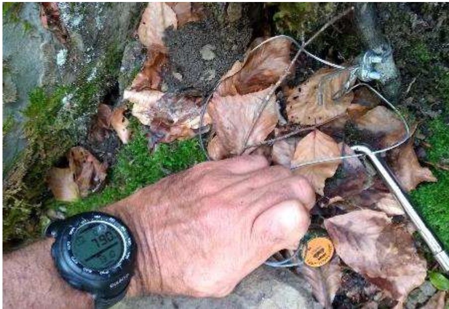
Fig. 20. Ancrage sur le terrain d'une sonde Onset Tidbit v2 (UTBI-001).
