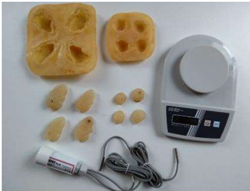
Fig. 21. Moules en latex et modèles biomimétiques en agarose utilisés pour les expérimentations de déshydratation. Les modèles sont couplés sur le terrain à une sonde Onset HOB0 prov2 TT et pesés au moyen de la balance de précision portable Kern EMB-202 (précision 0,01 g).
