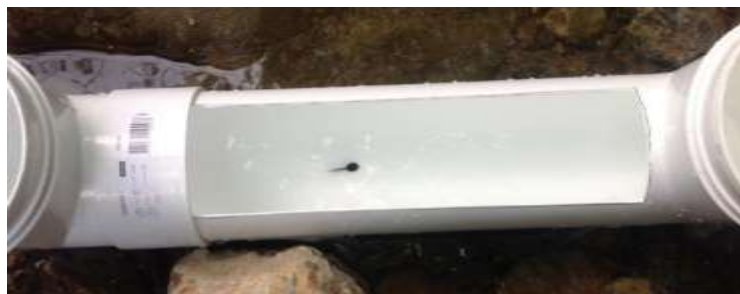
Fig. 254. Têtard nageant dans le 'couloir de nage' inventé et construit de novo spécialement pour ce travail dans un tube en PVC (F. D'Amico)
